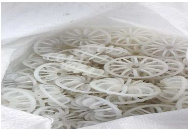
ปรับปรุง PACKING MEDIA ภายในระบบบำบัดอากาศใหม่ (Waste gas scrubber) วันที่ 28 พฤศจิกายน 2565
